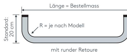
Bei Aluschiene von Wand zu Wand ergibt sich die Länge = Mauerlichte abzüglich 1 cm Luft.
